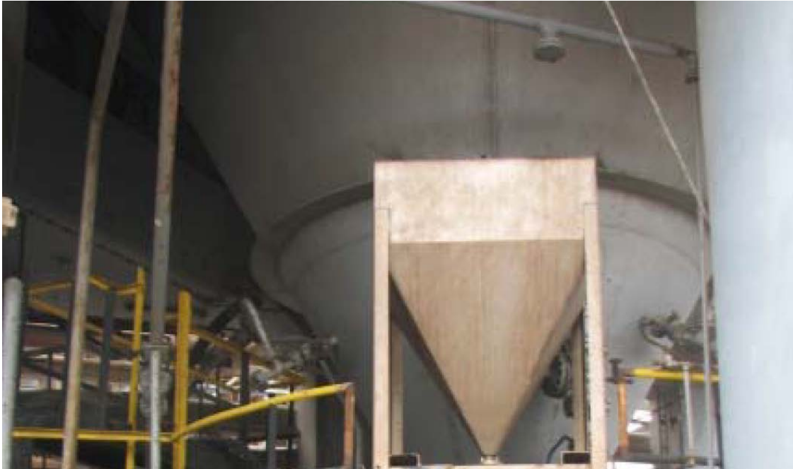
Afbeelding 7.3: de doseerinstallatie voor het DeSO x additief
