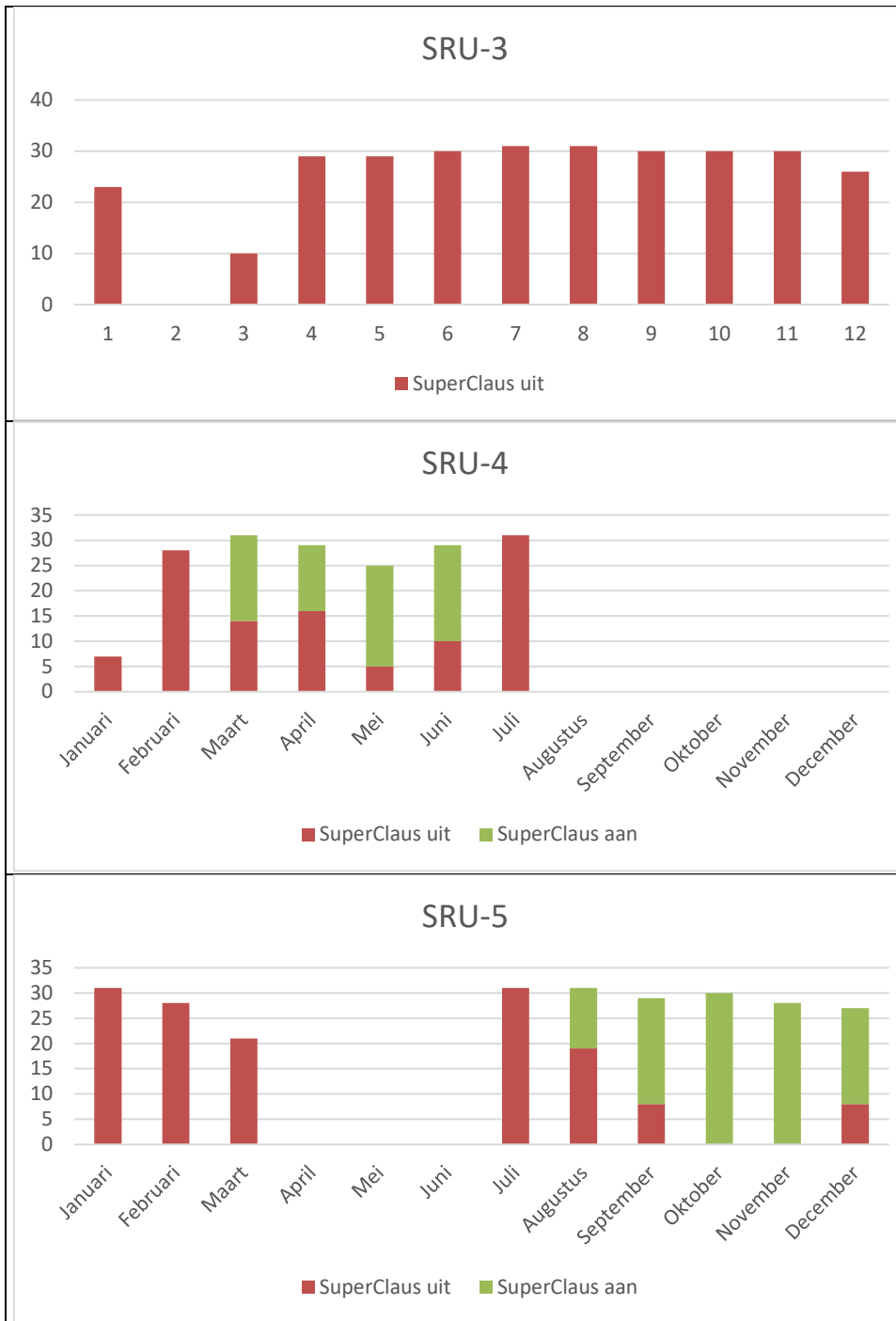
Afbeelding 8.8: Grafische weergave van de procesmodi waarop de (Super)Claus reactoren hebben geopereerd in 2014
