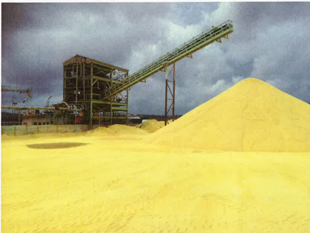
Afbeelding 7.3: Opslag van door de SRU's geproduceerde zwavel in pelletvorm
