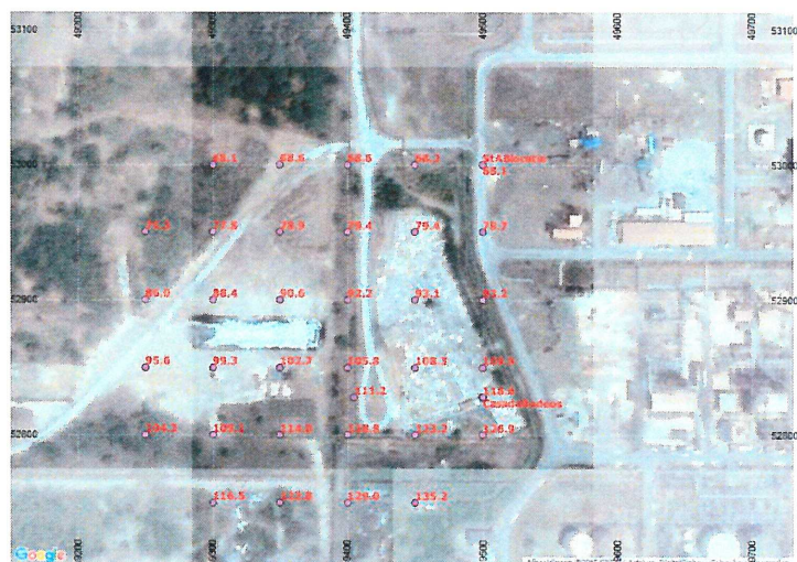
Figuur 1 Resultaten van de berekeningen (“average case”) van de jaargemiddelde concentratie van zwaveldioxide (SO 2 ) op de begraafplaats (‘te Beth Chaim’) en diverse overige plaatsen benedenwinds van de Isla-raffinaderij op basis van de door de StAB gebruikte invoergegevens en conform de door de StAB gebruikte methode.
